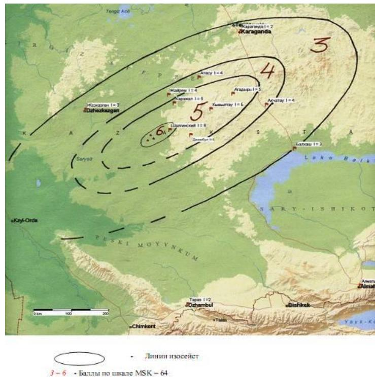
Рисунок 6.3 – Слева–карта изосейст Шалгинского землетрясения 22 августа 2001 года с  $Mw=5,2$ ,  $K=13,2$  [51, с.326].
